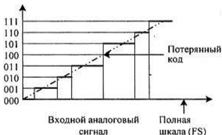
Рис. 13.28. Функция передачи неидеального 3-разрядного АЦП
