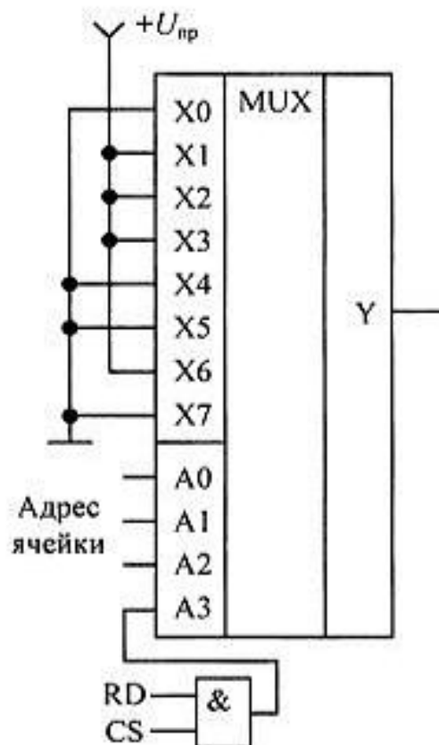
Рис. 15.12. Схема простейшего постоянного запоминающего устройства, построенная на мультиплексоре
