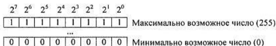
Рис. 18.1. Формат 8-разрядного беззнакового двоичного кода
