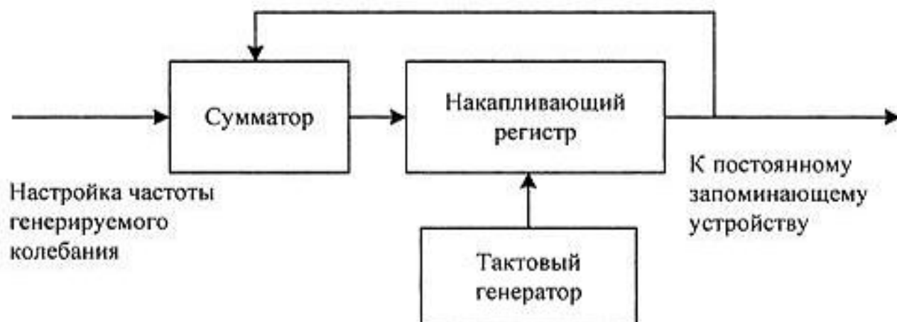
Рис. 16.3. Структурная схема фазового аккумулятора
