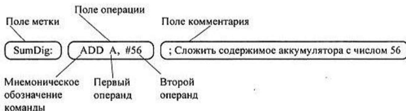
Рис. 23.2. Пример оператора, записанного на языке программирования ASM-51
