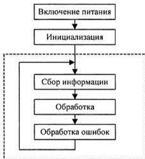
Рис. 21.10. Схема алгоритма программы-монитора
