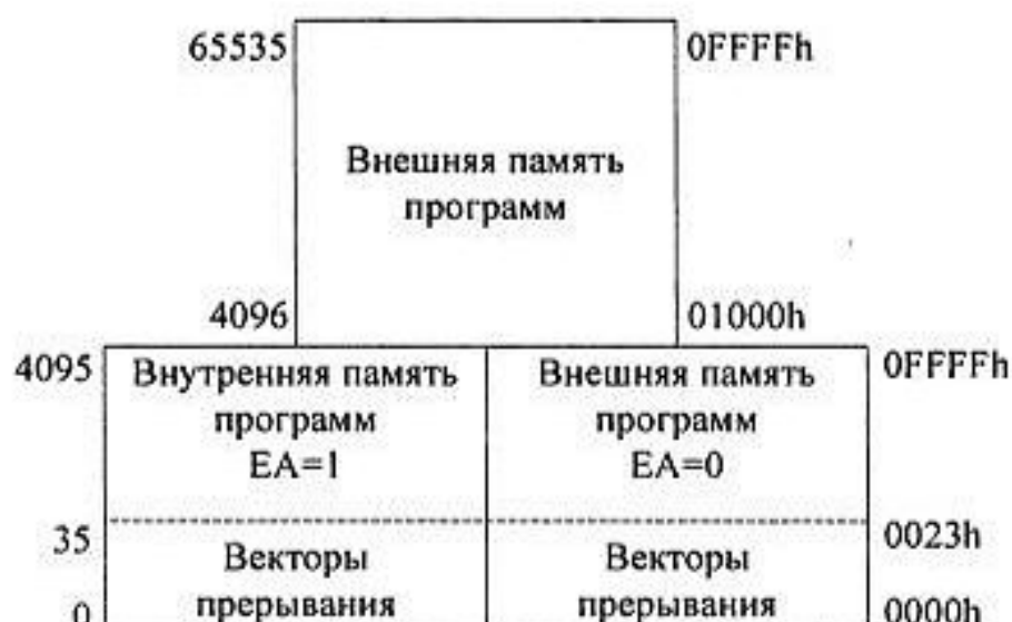
Рис. 20.10. Распределение памяти программ микроконтроллеров КР1830ВЕ51
