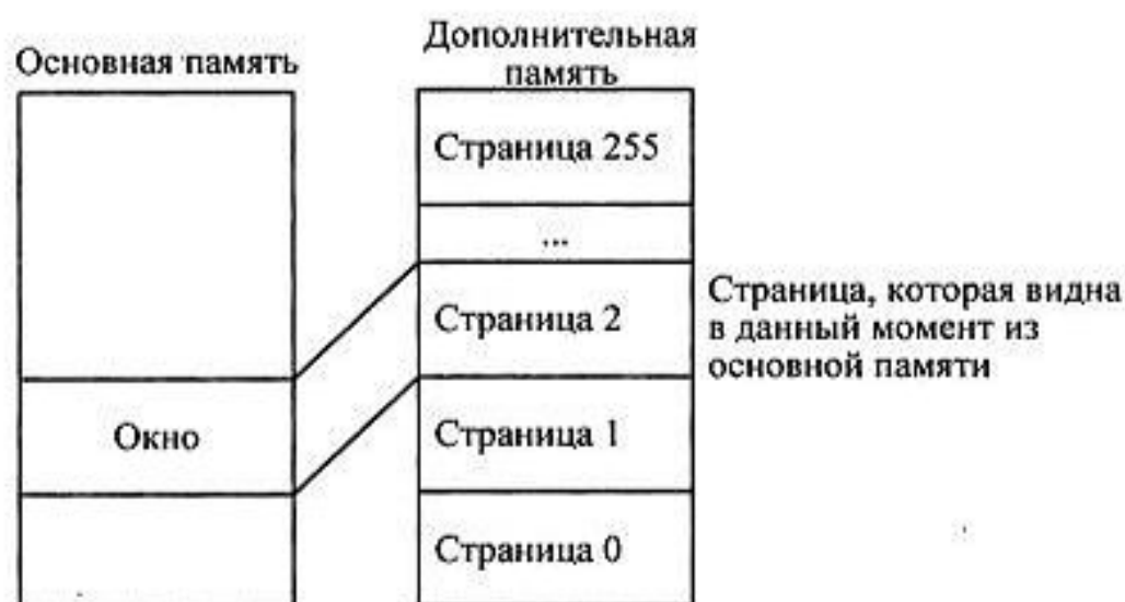
Рис. 19.34. Применение окна для расширения адресного пространства
