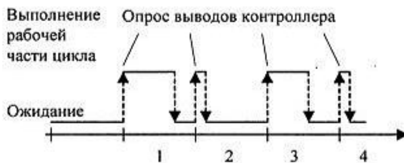
Рис. 21.15. Соотношение времени выполнения рабочей части цикла и ожидания срабатывания таймера
