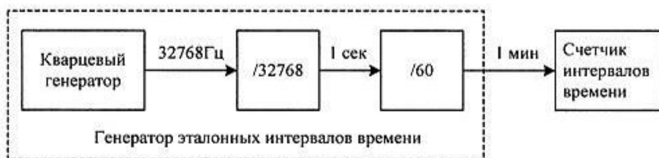
Рис. 10.5. Уточненная структурная схема устройства измерения времени
