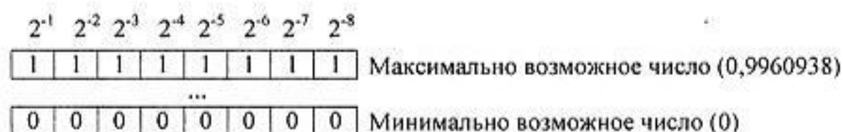
Рис. 18.14. Формат 8-разрядного дробного беззнакового двоичного кода
