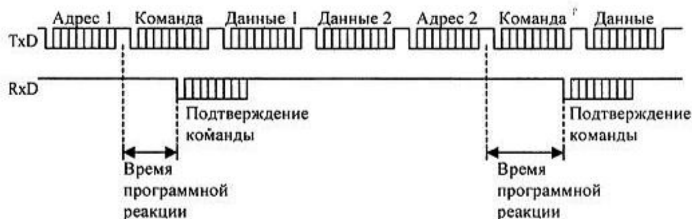
Рис. 20.32. Временная диаграмма работы многопроцессорной последовательной шины
