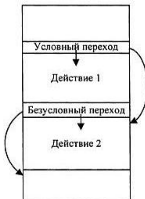
Рис. 21.6. Размещение различных частей конструкции управления условным выполнением операторов в памяти программ микропроцессора
