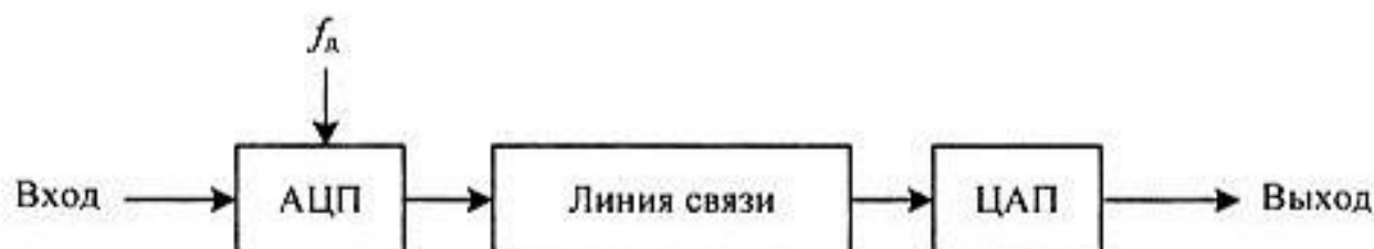
Рис. 14.6. Структурная схема линии связи с импульсно-кодовой модуляцией
