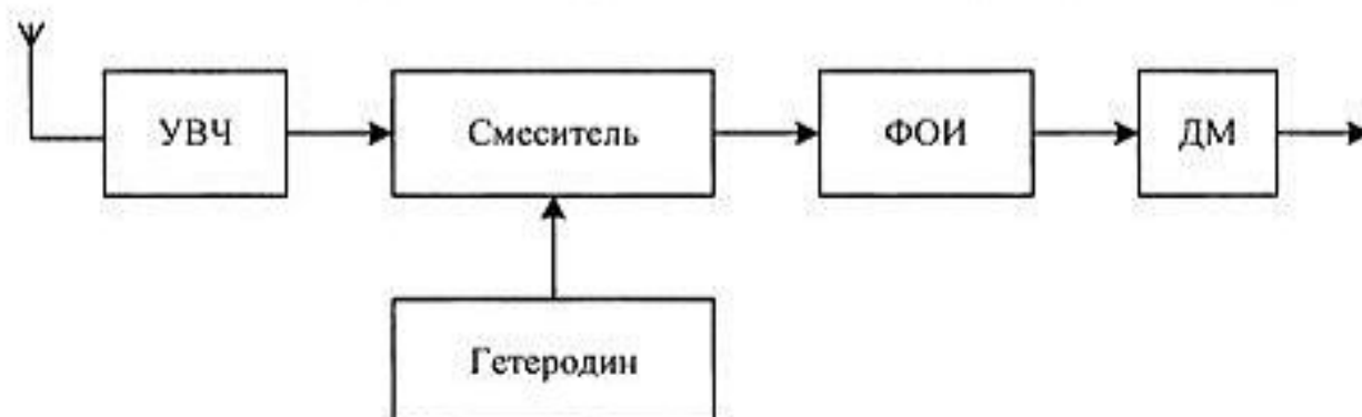
Рис. 17.1. Структурная схема супергетеродинного приемника
