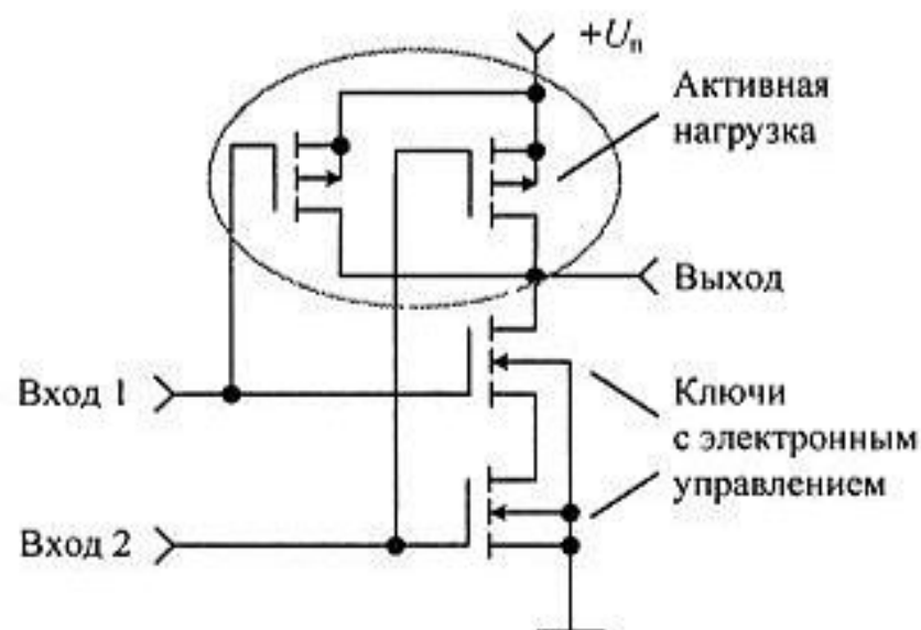
Рис. 3.16. Принципиальная схема элемента "2И-НЕ", выполненного на комплементарных МОП-транзисторах
