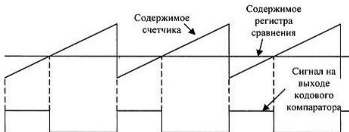
Рис. 19.27. Формирование широтно-импульсного сигнала на выходе кодового компаратора
