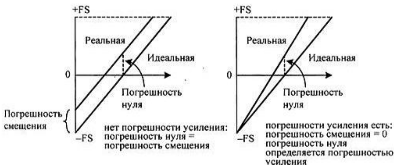
Рис. 13.24. Погрешность смещения нуля преобразователя и погрешность усиления
