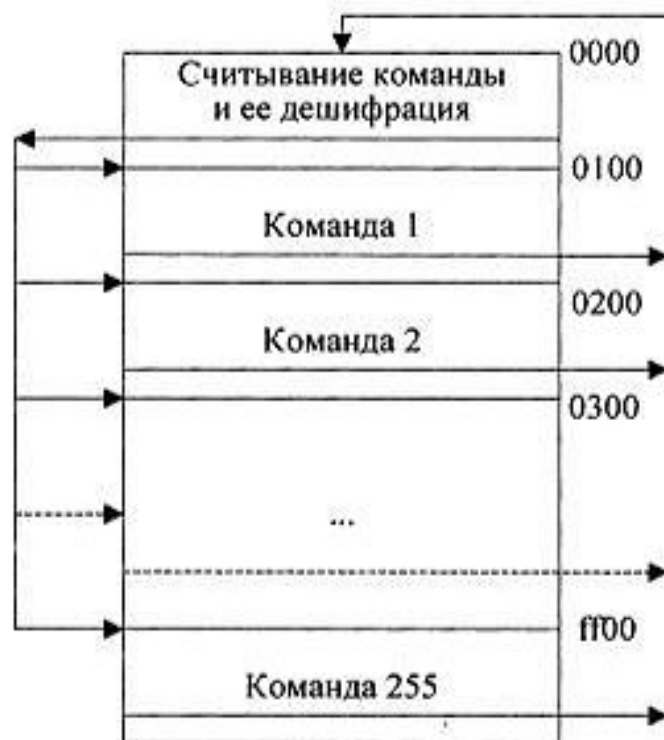
Рис. 18.33. Размещение микропрограмм в ПЗУ
