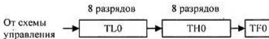
Рис. 20.15. Схема таймера T0 , работающего в режиме 1
