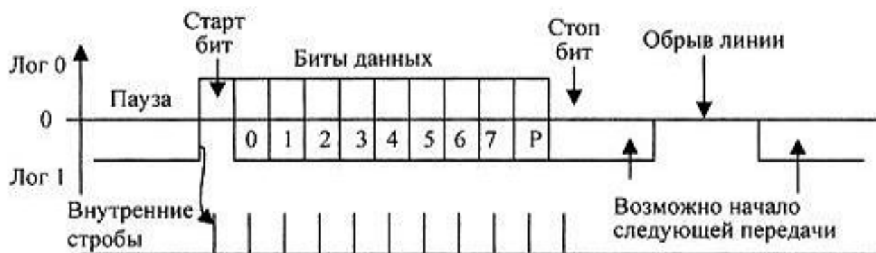
Рис. 19.19. Временная диаграмма передаваемых сигналов интерфейса RS-232
